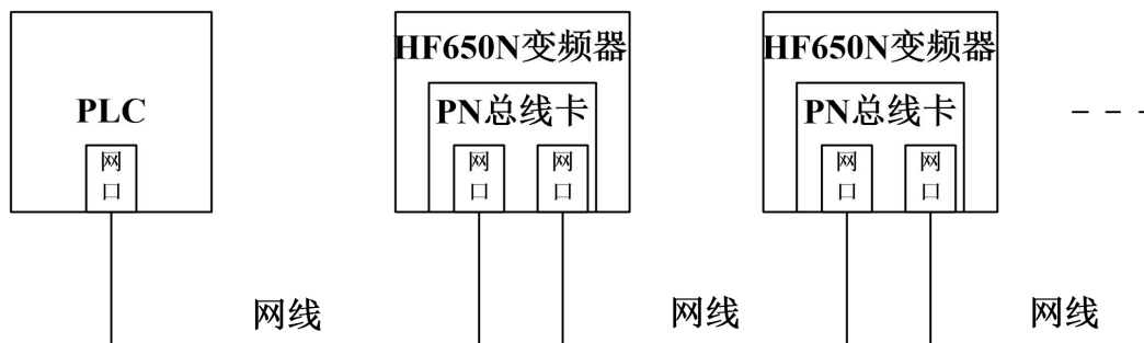
图 1 标准 PROFINET 电缆接线图
